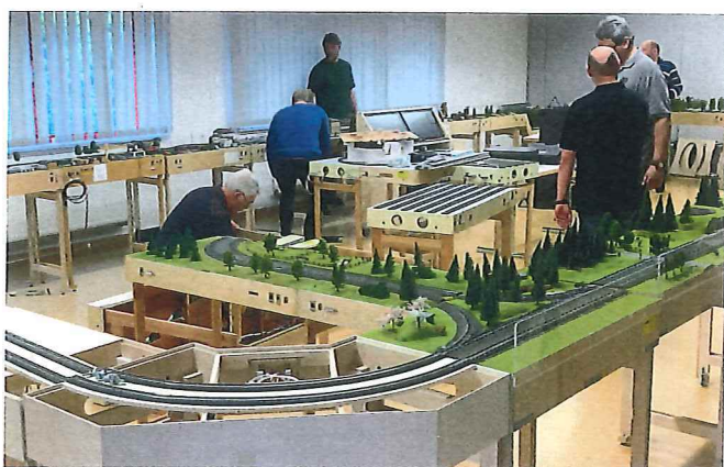
Technikprüfung: Ein automatisierter Fahrbetrieb erfordert im Vorfeld sorgsames Testen – Mitglied Michael Ptok prüft die Kontakte im Schattenbahnhof, der programmtechnisch eingebunden ist, was einen Zugwechsel im laufenden Betrieb möglich macht.
