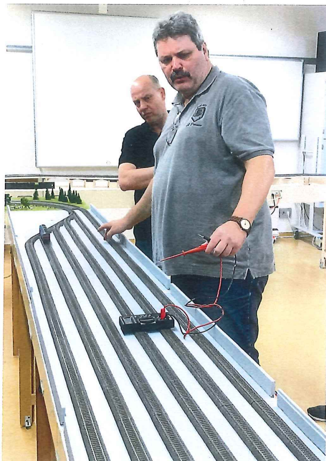
Technikprüfung: Ein automatisierter Fahrbetrieb erfordert im Vorfeld sorgsames Testen – Mitglied Michael Ptok prüft die Kontakte im Schattenbahnhof, der programmtechnisch eingebunden ist, was einen Zugwechsel im laufenden Betrieb möglich macht.
